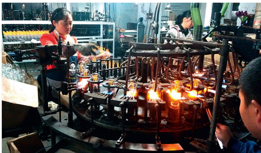
Bild 4 Glas-Montage auf Rotationsautomat (Verschmelzung).
