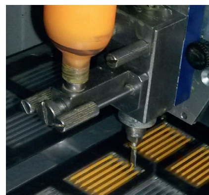
Bild 3 Phosphor-Beschichtung der Saphir-Glas-Filamente
